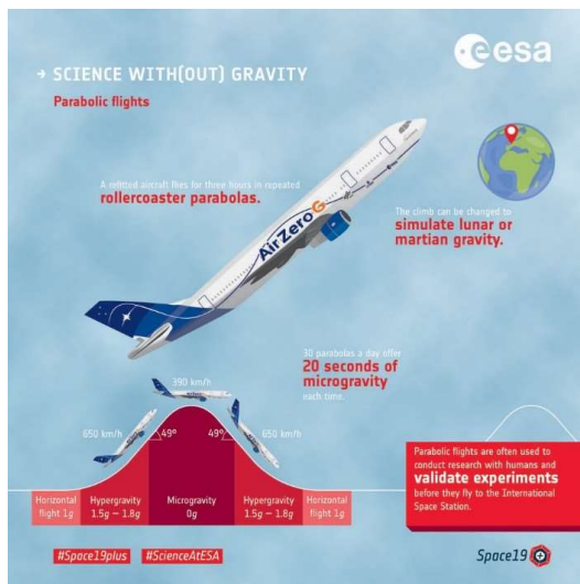
Ryc. 4. Schemat lotu parabolicznego przygotowany przez ESA ([5])
